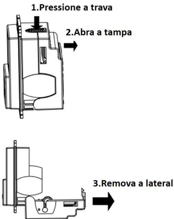
2. Limpe as partes internas do seu aparelho utilizando um pano macio. A passagem das cédulas e os sensores devem estar sempre desobstruídos para garantir o bom funcionamento do seu aparelho e a alta taxa de aceitação. **\*\*Não utilize líquidos voláteis ou solventes. \*\***
